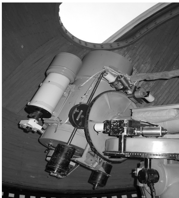
Рис. 1. Автоматизированный телескоп Зеркальный астрограф ЗА-320М (система Кассегрена; D = 320 мм, F = 3200 мм; ПЗС-камера FLI IMG 1001E ( 1024 \times 1024 пикс., 24 \times 24 мкм, фильтры BVRI); поле зрения \approx 28' \times 28' )
