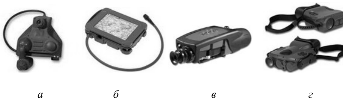
Рис. 3. Цифровой комплект экипировки FELIN: а – оптоэлектронная система; б – терминальная инфосистема; в – малогабаритная видеокамера; г – универсальный ИК-бинокль
